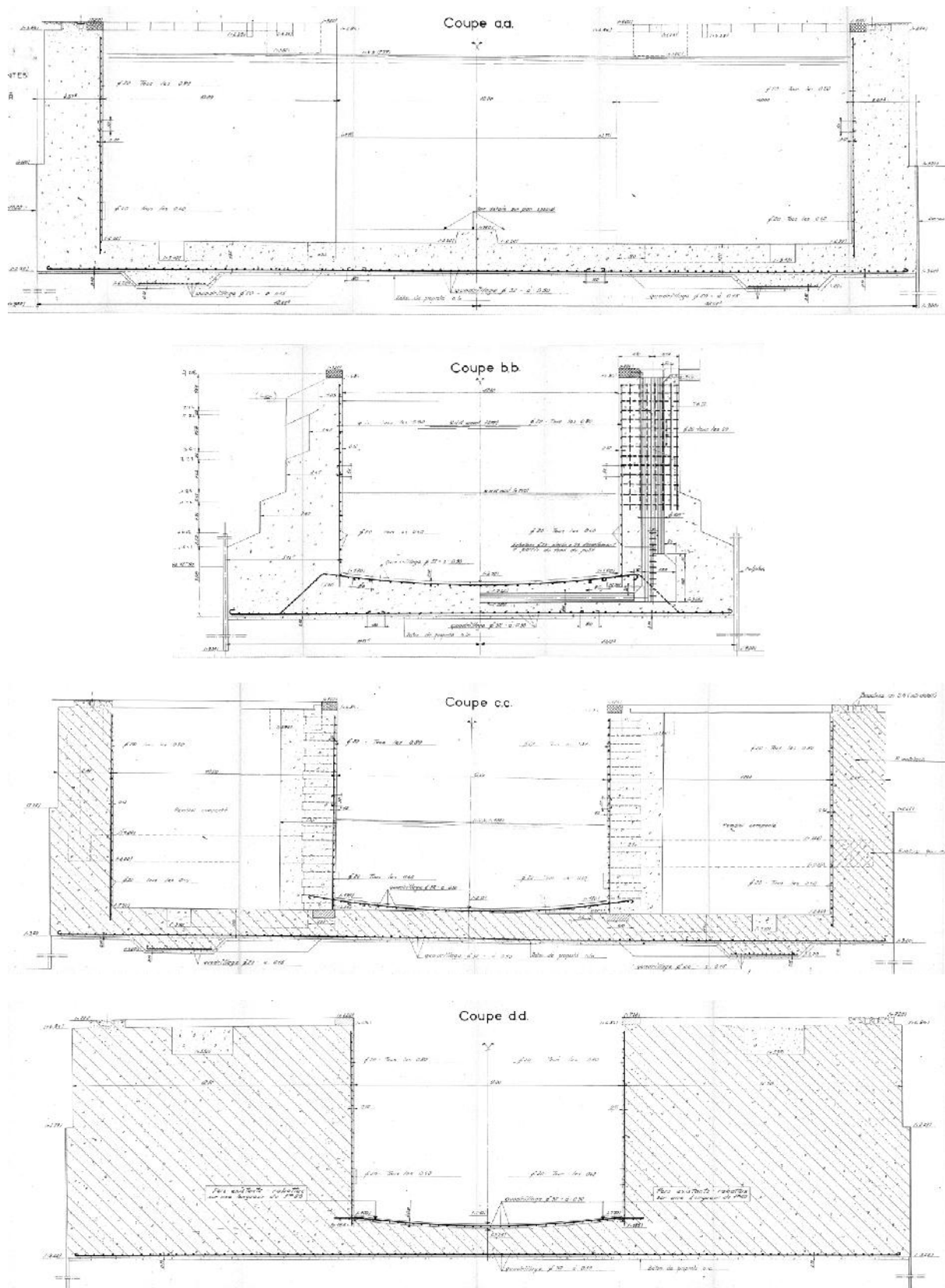
Figure 2-5 ; Coupes transversales du sas
